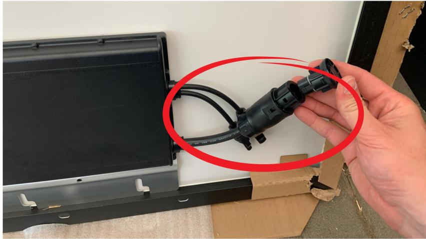
Abdeckkappe auf die **kürzere dicke** Leitung stecken, die vom Wechselrichter kommt
