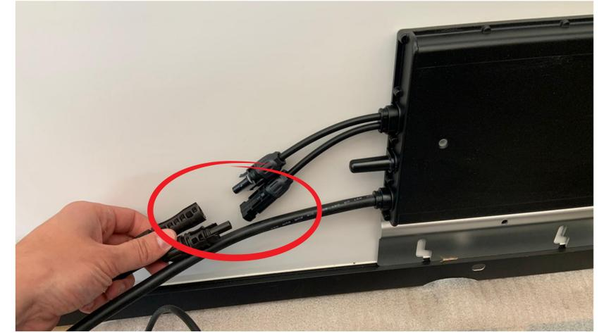
Beide **MC4 Stecker** von Modul 1 mit dem **Wechselrichter** verbinden. Danach Modul 2 analog an die andere Seite des Wechselrichters anschließen
