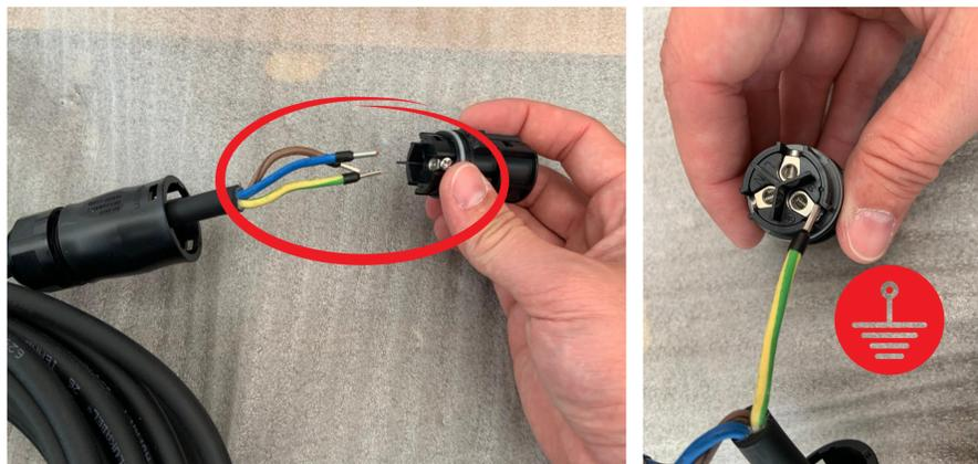
**Litzen** des Kabels durch die Schutzkappe führen und mittels Schraubenzieher am **Stecker** befestigen. Darauf achten, dass das gelb-grüne Kabel am Erdungszeichen
